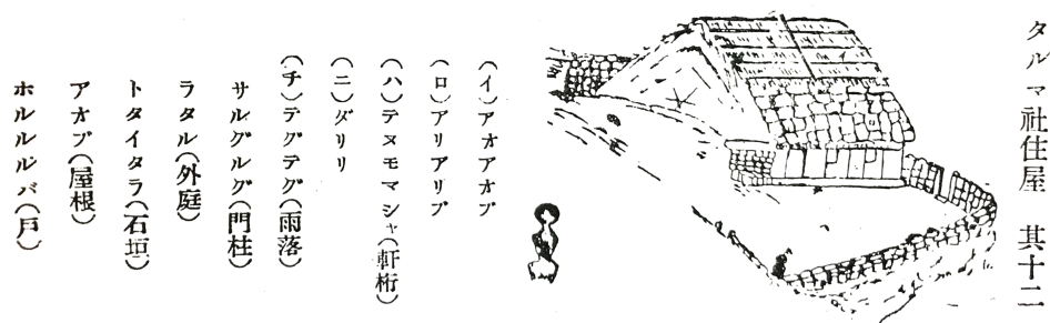
図6 旧部落 kapaliwa の伝統的な石板屋の概念図 (台湾総督府蕃族調査会蕃族調査報告書-排灣族・獅設族, 台湾総督府蕃族調査会, 157, 1921)
