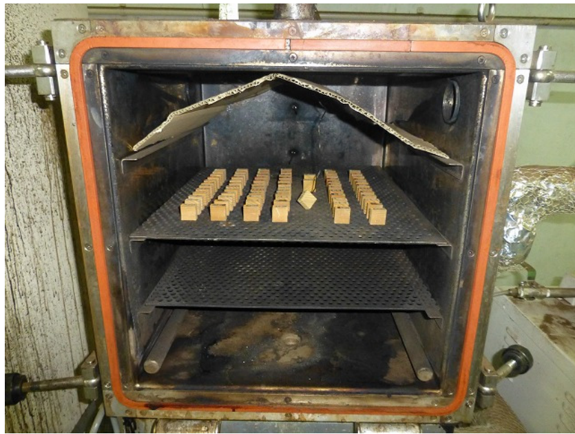
図 2. 3 試験体の配置
