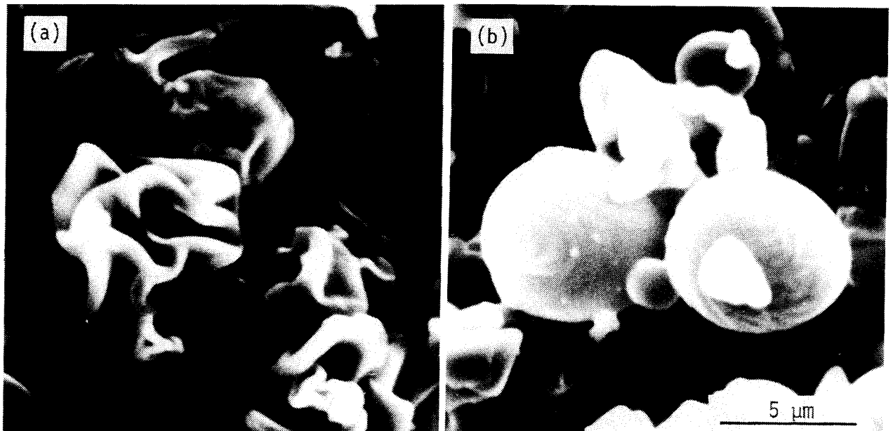
図16 噴霧乾燥によって調製したリノール酸含有グリアジン微粉末の走査型電子顕微鏡写真 (a)はリノール酸とパルミチン酸混合物 (w/w) 20%を含んでいないグリアジン粉末, (b)は含んでいるものである。
