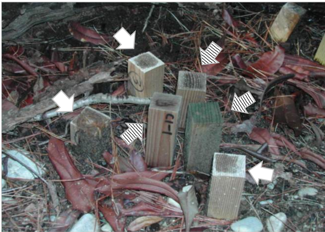
図 3 - 8 野外耐蟻性試験の様子 (和歌山県日高郡美浜町)
