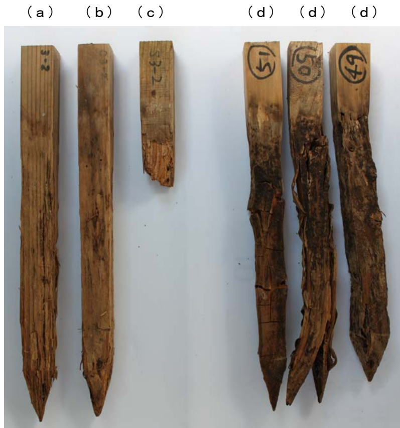
図3-11 野外耐蟻性試験2年経過後の試験体の様子
